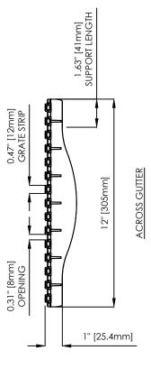
Silentflow DPAS: ALL COMPONENTS ARE CORROSION RESISTANT,
